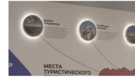
короб из пластика с торцевой подсветкой вынос 50 мм
